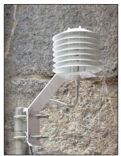
PS7P. Aísla el sensor de temperatura y humedad de la radiación solar y de otras fuentes de calor irradiado y reflejado.
