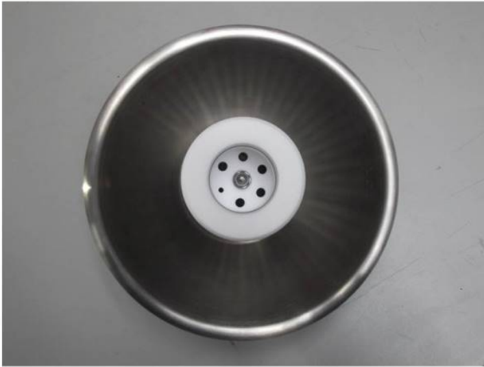
Fig. 3: Capçal d'aspiració de gasos CAG-ER (vista superior)
